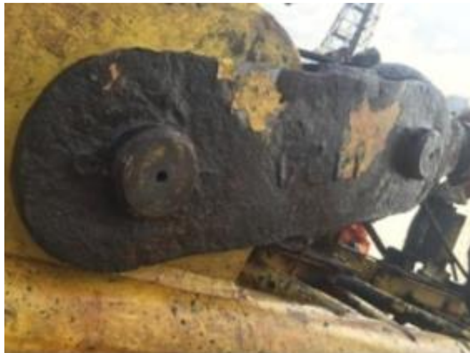
Hình 5: Gối lắp chốt cáp cương và chốt nối bị hư hỏng
