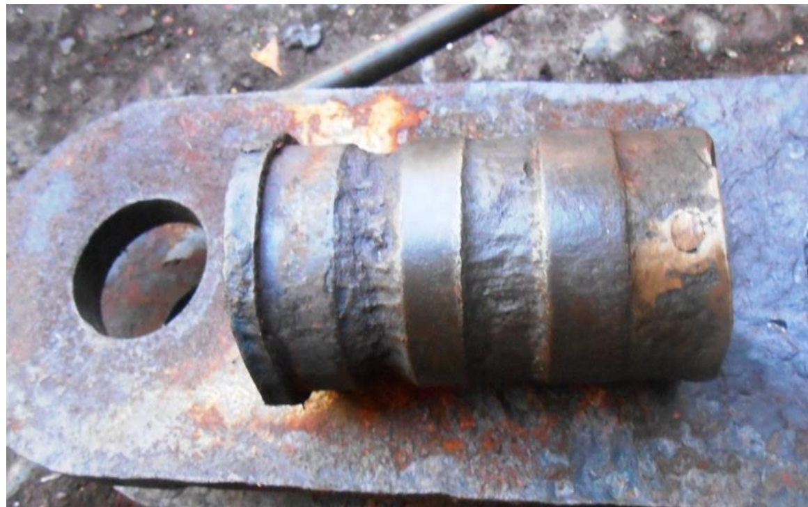
Hình 5: Gối lắp chốt cáp cương và chốt nối bị hư hỏng
