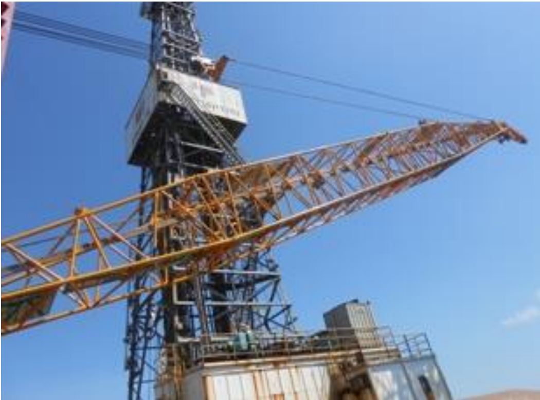
Hình 1: Thanh cần Favelle Favco trên giàn khoan tự nâng của VSP và giàn Ruby B-PVEP
